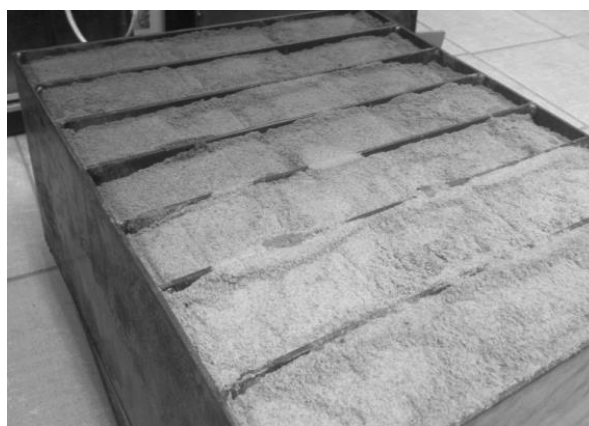
Рис. 1. Экспериментальная установка термической модификации измельченной древесины в плотном слое
