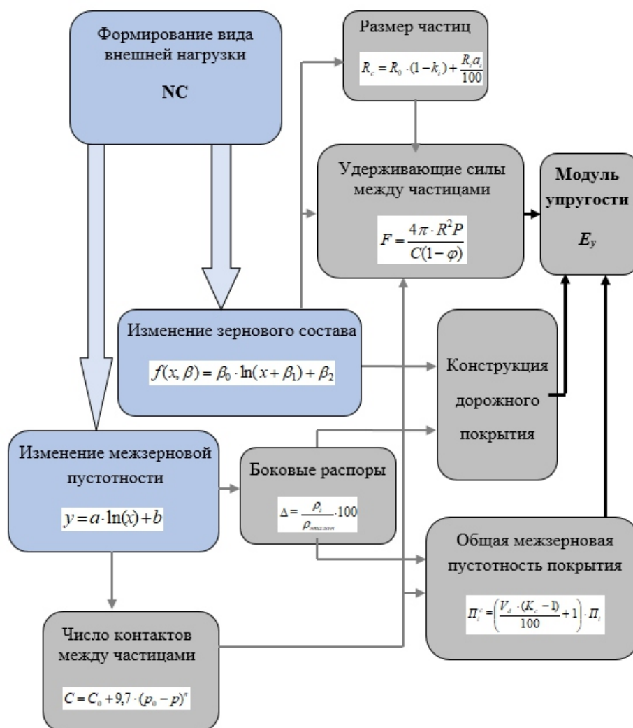
Рис. 2. Структурная схема оценки транспортно-эксплуатационного состояния дорожного покрытия
