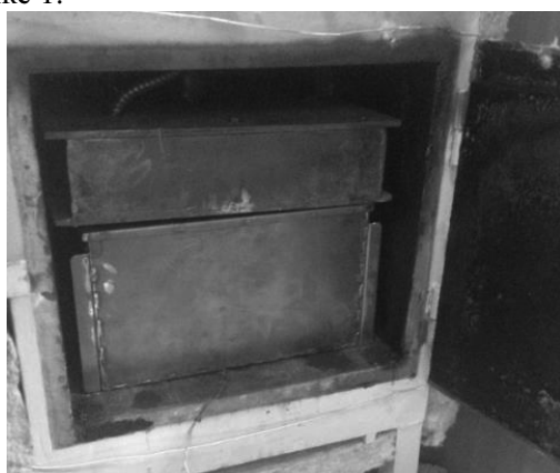
Рис. 1. Экспериментальная установка термической модификации измельченной древесины в плотном слое
